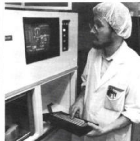
Programmering van een volledig programmeerbare installatie voor reactief ionen-etsen. Om de kleine BICMOS-structuren met de noodzakelijke reproduceerbaarheid en definitie van de verticale ribprofielen te kunnen vervaardigen, zal Telefunken electronic deze etsmethode toepassen inplaats van nat etsen of plasma-etsen.
