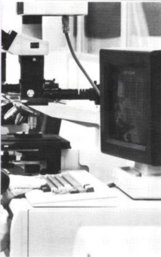
Visuele inspectie van kritische dimensies van GaAs-IC's met kleinste lithografische details van circa 1 \mu\text{m} (kanaallengten van de MESFET's) in Honeywell's GaAs-fabriek te Richardson (Texas).
